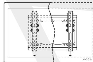
Montaje del televisor en la pared. Se necesita dos personas para levantar el televisor plano y colgarlo en los brazos de la lámina de pared. No suelte las manos hasta que el aparato esté colgado con firmeza en los brazos.
